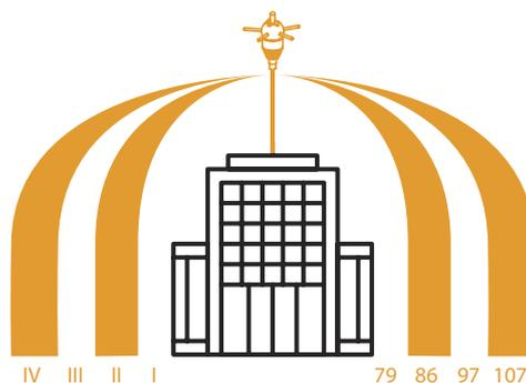
El nivel de protección se determina con la norma NFC 17-102 ed. 2011, o EN 62305-2, o con el guía FDC 17-108. Si existe un riesgo para el medio ambiente, el radio de protección debe ser reducido de un 40%. Para un nivel de protección I++ (Ver 5.2.3.5 NFC 17-102), el radio de protección debe también ser reducido de un 40%.
